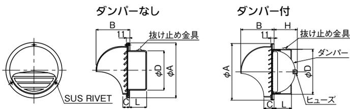
防火ダンパー付は建築基準法の「特定防火設備」に該当しています。また、「品確法の住宅性能表示制度」においても、耐火等級規定の最上級にあたる3等級の基準をクリアしています。
