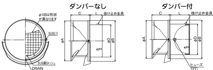
防火ダンパー付は建築基準法の「特定防火設備」に該当しています。また、「品確法の住宅性能表示制度」においても、耐火等級規定の最上級にあたる3等級の基準をクリアしています。
